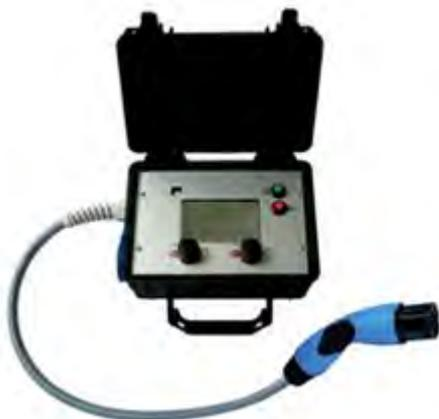
La funzionalità del sistema di ricarica installato può essere testata con un veicolo elettrico o con un simulatore di funzioni.
