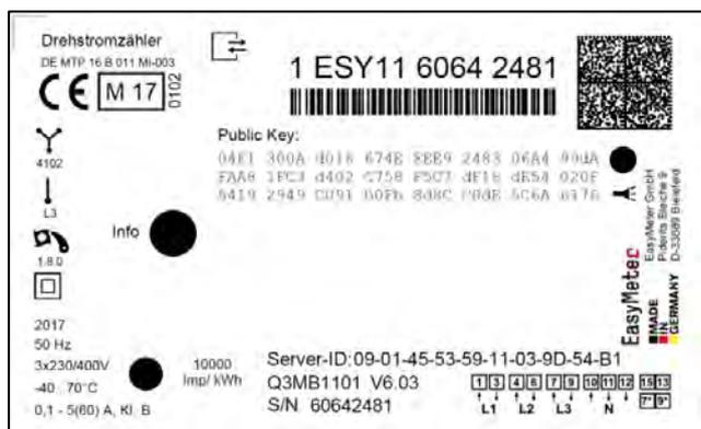
Figura 3: Targa portadati del contatore (esempio)
