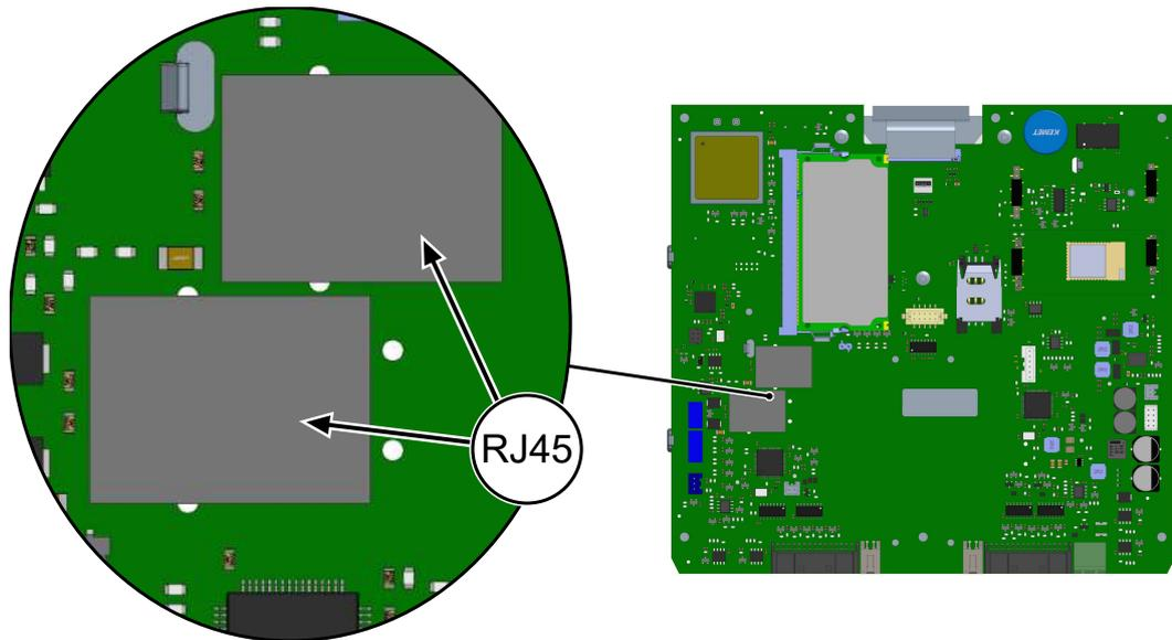
1. Anschluss-Buchsen (RJ45) auf der Steuer-Platine identifizieren.
