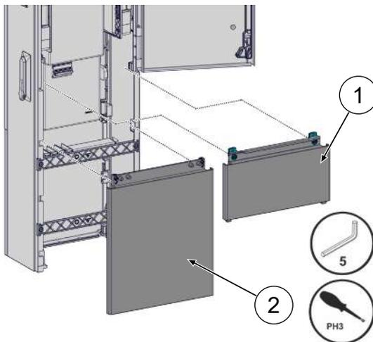
1. Mittlere Frontplatte lösen und entfernen.
