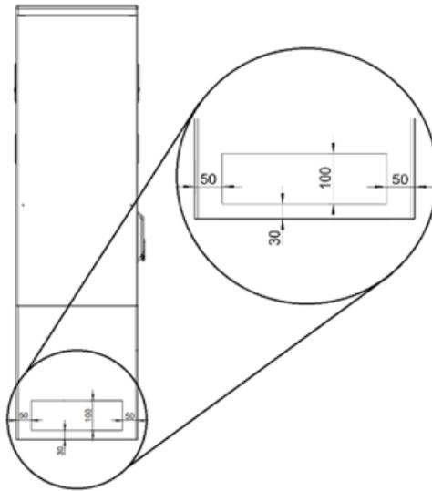
1. Zusätzliche Bohrungen mit einem passenden Bohrer im markierten definierten Bereich an der Geräteseite einbringen.
