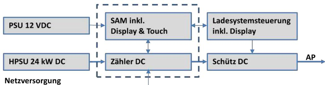
Links ist das 12 V Netzteil zur Versorgung des SAMs und der Steuerung. In unmittelbarer Nähe befindet sich die Netzversorgungsleitung zum Zähler (hier sind ggf. LS-Sicherungen u.a. Komponenten vorgeschaltet).
