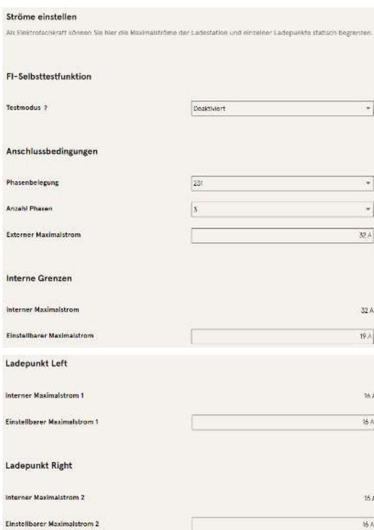
Im Ordner “Ströme” kann die Elektrofachkraft die FI-Selbsttestfunktion einstellen und die Anschlussbedingungen spezifizieren.
