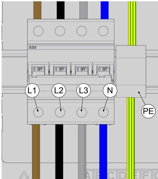
5. Alle Leiter der Versorgungsleitung gemäß nebenstehender Abbildung auf der externen Verdrahtungsseite anschließen.
