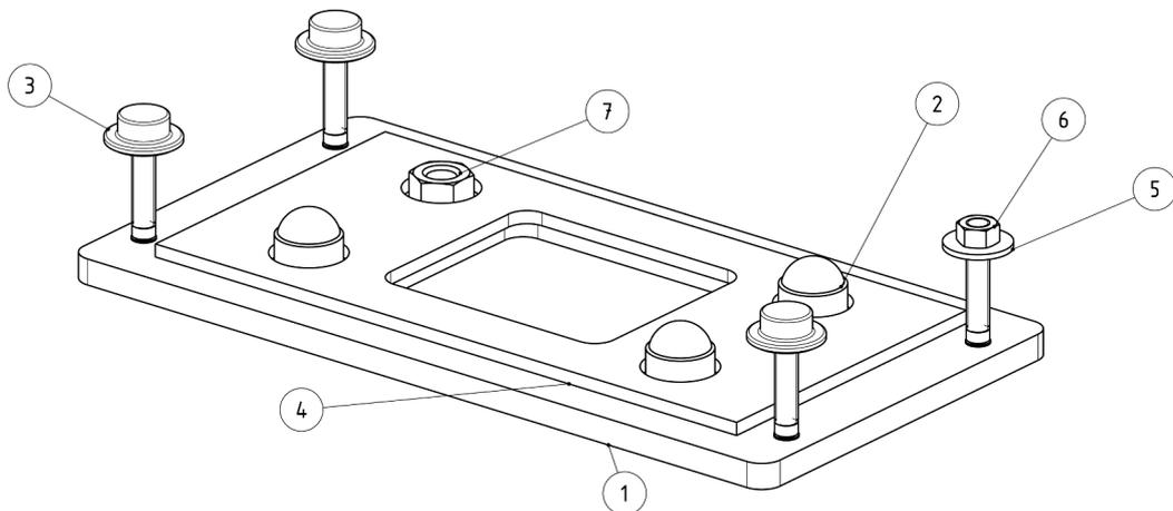
5. Untere Adapterplatte (1) über die Gewindebolzen (B) auf die Auflagefläche (A) des Sockels legen. Dabei kontrollieren, dass keine Zuleitungen gequetscht werden.
