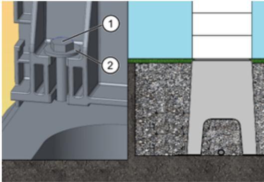
1. Ladesystem auf dem vorbereiteten SMC-Sockel platzieren. Dabei kontrollieren, dass keine Zuleitungen gequetscht werden!
