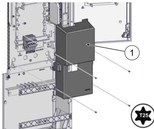
1. Befestigungsschrauben der Hauptschalter-Abdeckung (1) lösen und Abdeckung entfernen.
