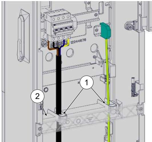
1. Schellen (1) der Zugentlastung über die Zuleitungen führen und auf die Profilschiene (2) stecken.
