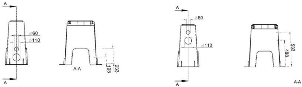
1. Wie in den Abbildungen angezeigt, zusätzliche Bohrungen mit einem passenden Bohrer in markierten definierten Bereichen am SMC-Sockel einbringen.
