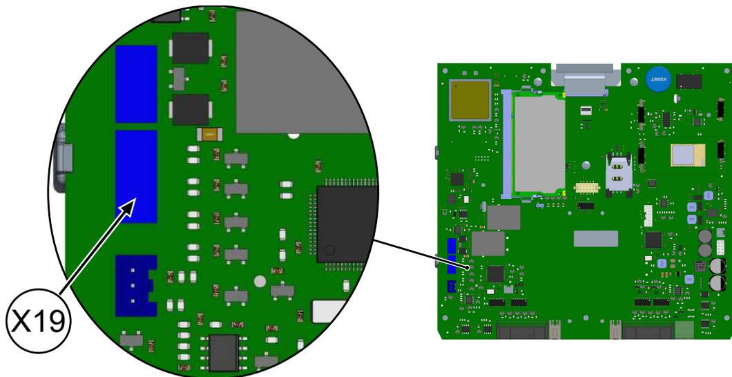
1. Anschluss-Buchse (X19) auf der Steuer-Platine identifizieren.
