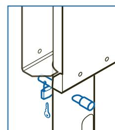
Dispositif antivol (en option) des eBOXes par un cadenas avec des boulons en acier (LOCK ePOLE)
