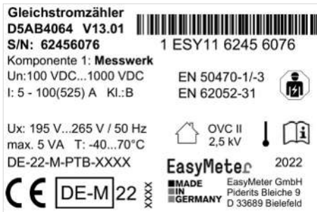
Abb. oben: Sicherheitsetikett MW, Größe: 60 mm x 40 mm, beispielhaft (Stand: 2022-01-14, Laserbeschriftung ähnlich)
