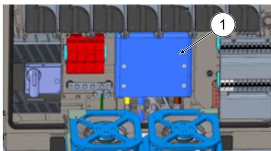
5. Mitgelieferten Schutzdeckel (1) montieren (TX45, M = 15 Nm)
