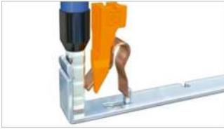
Beim Schraubanschluss ist die Verwendung von Aderendhülsen obligatorisch, beim Push-in-Anschluss dürfen diese ggf. auch entfallen (dann ist beim Einstecken der orangefarbene Drücker mittels eines kleinen Schlitzzraubendrehers zu betätigen).
