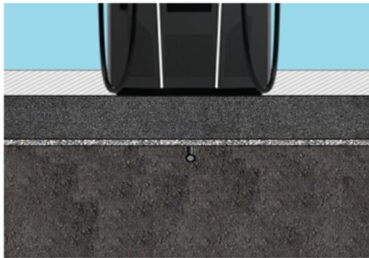
L'installazione avviene su asfalto preparato o su sottofondo in calcestruzzo.
