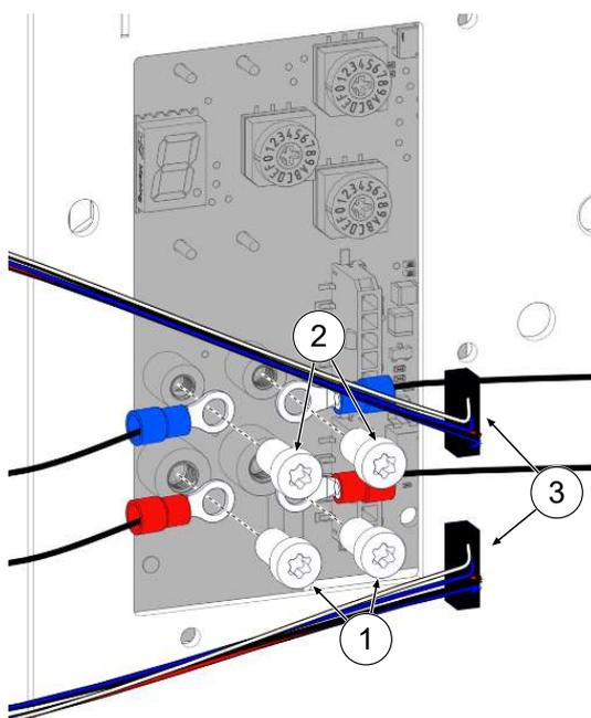
4. Collegare i cavi inferiori (1) dei collegamenti centrali con viti M5 x 6 e rondelle coniche M5.
