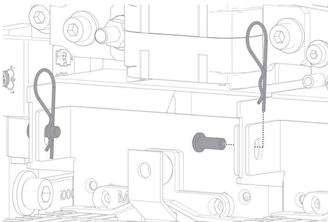
1. Rimuovere i perni a molla dai bulloni di fissaggio all'estremità superiore del modulo LE.
