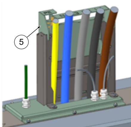
9. Inserire la dima di collegamento (5) sulla calotta di protezione e piegare in avanti i cavi ancora da accorciare.
