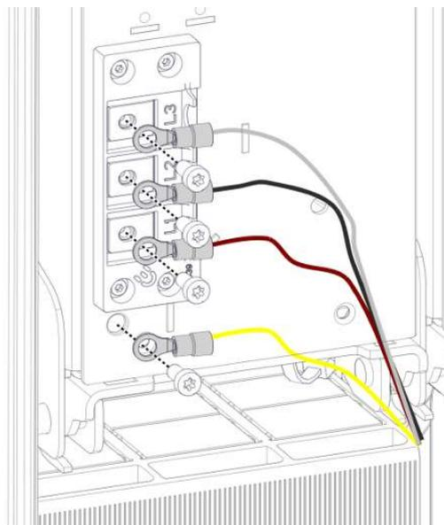
2. Collegare i cavi dei collegamenti inferiori con viti M5 x 10 e rondelle coniche M5.
