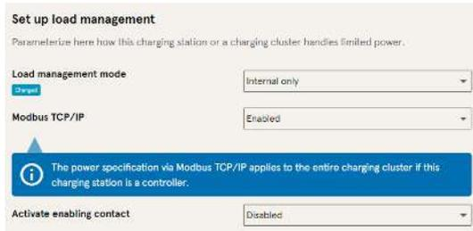
A seconda che la modalità di gestione del carico sia impostata su “Solo interno” o su “Controller”, da un gestore energetico di livello superiore si può controllare la singola stazione di ricarica o l’intero gruppo di punti di ricarica.
