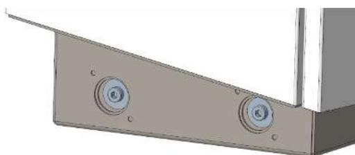
4. Avvitare lateralmente in 4 punti l'alloggiamento del sistema di ricarica alla mensola di collegamento. (Viti M 12 più viti per carrozzeria).
