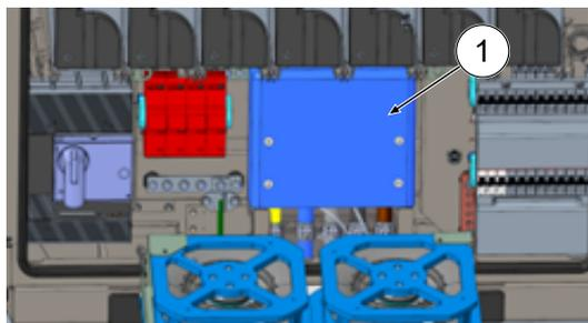
1. Collegare il cavo di collegamento alle sbarre collettrici utilizzando gli acclusi morsetti a V o i morsetti a doppia V come mostrato nella figura qui accanto (PE: M10, M = 35 Nm; N/L3/L2/L1: M12, M = 50 Nm).
