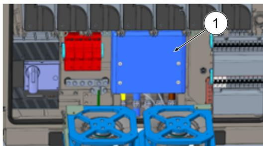
1. Anschlusskabel über die beiliegenden V-Klemmen oder Doppel-V-Klemmen an die Stromschienen gemäß nebenstehender Abbildung anschließen (PE: M10, M = 35 Nm; N/ L3/L2/L1: M12, M = 50 Nm).
